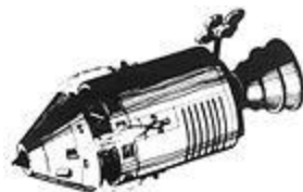
Пре уласка у Земљину орбиту, раздвајају се командни и сервисни модул
